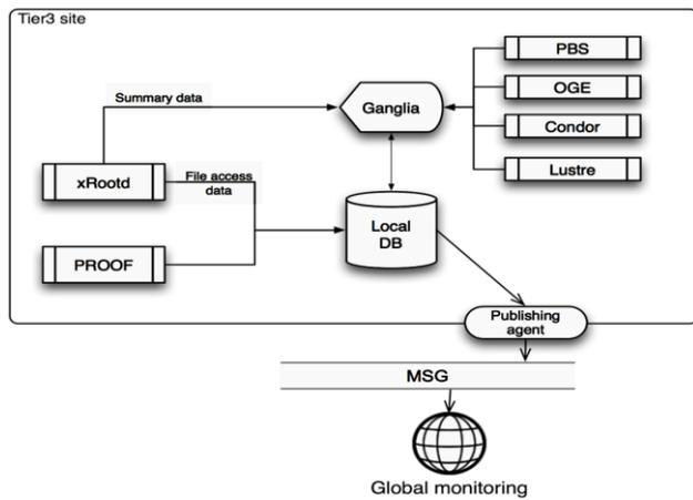
Рис. 6. Схема функционирования основных вариантов Tier3 центров и их взаимодействие с системой глобального мониторинга.
