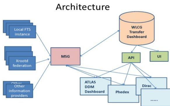
Рис. 7 Архитектура универсальной системы мониторинга передачи файлов
